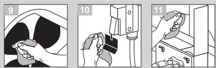
12. Souffler avec précaution l'intérieur de l'appareil ou nettoyer les tôles d'arrivée d'air et la tête du brûleur avec un chiffon.
