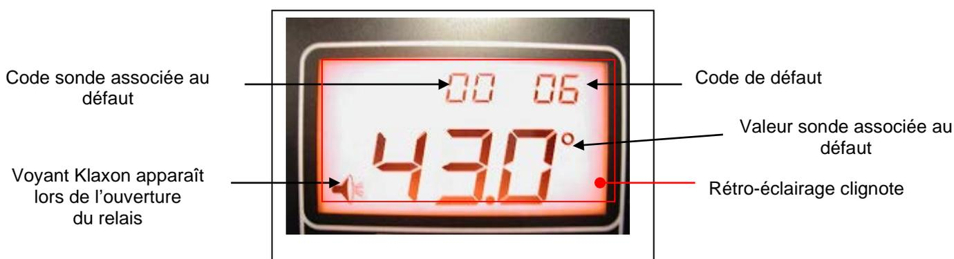
Par exemple ici on peut imaginer un défaut **Seuil Haut Alarme Ambiance** car la sonde de **Température Ambiante** (*code Utilisateur 20*) mesure une température de 43 ° et affiche un défaut de type 06.
