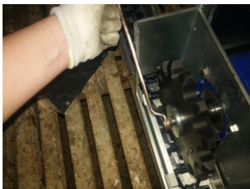
Ajustez le trou de la goupille de sécurité avec le manchon d'arbre
