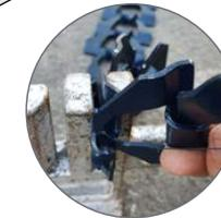
2. Connectez les extrémités de la chaîne entre eux en utilisant une enclume et un marteau
